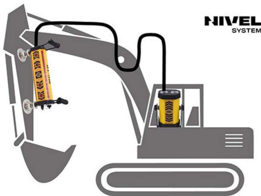
Schemat podłączenia z zasilaniem wewnętrznym
