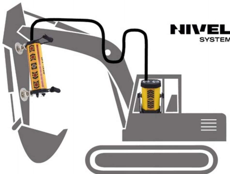
Schemat podłączenia z zasilaniem wewnętrznym
