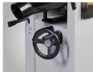
Regulacja stołu grubiarki za pomocą pokrętki ze wskaźnikiem numerycznym (precyzja 0,1 mm)
