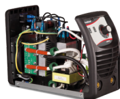
Elektronika zabezpieczona lakierem ochronnym
