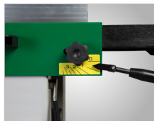
Przestawienie grubości wióra za pomocą dźwigni obsługowej
