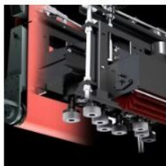
ŁĄCZY 3 RODZAJE ZESPOŁÓW ROBOCZYCH( WAŁEK SZCZOTKOWY B, TARCZOWY D).
