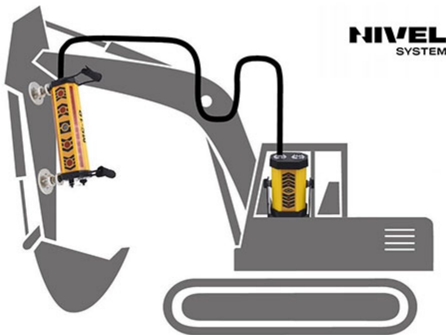
Schemat podłączenia z zasilaniem wewnętrznym
