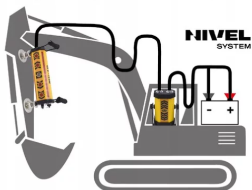
Schemat podłączenia z zasilaniem zewnętrznym
