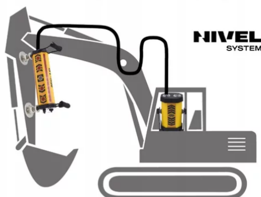
Schemat podłączenia z zasilaniem wewnętrznym
