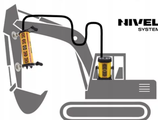
Schemat podłączenia z zasilaniem wewnętrznym
