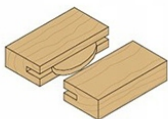
Połączenie Lamelo używając frezów #7/8/911.040.11
