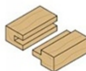
Połączenie na pióro-wpust
