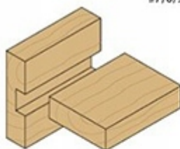
Połączenie pod kątem prostym
