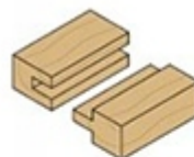
Połączenie na pióro-wpust
