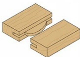
Połączenie Lamelo używając frezów #7/8/911.040.11
